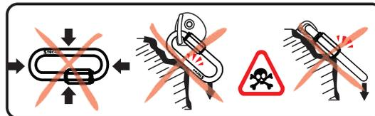
Não submeter a forças nos eixos transversais ou sobre o fecho do conector.
