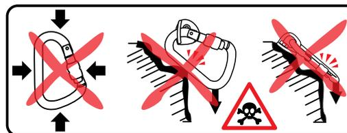
Não submeter a forças nos eixos transversais.
